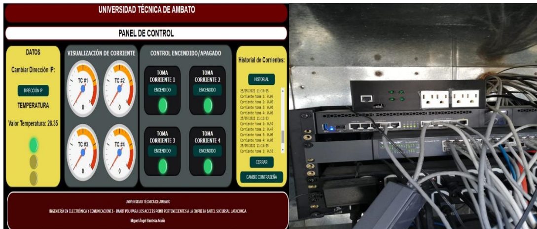
Figura No. 18 Implementación del prototipo en los Access point de la empresa SAITEL Fuente: Investigador
