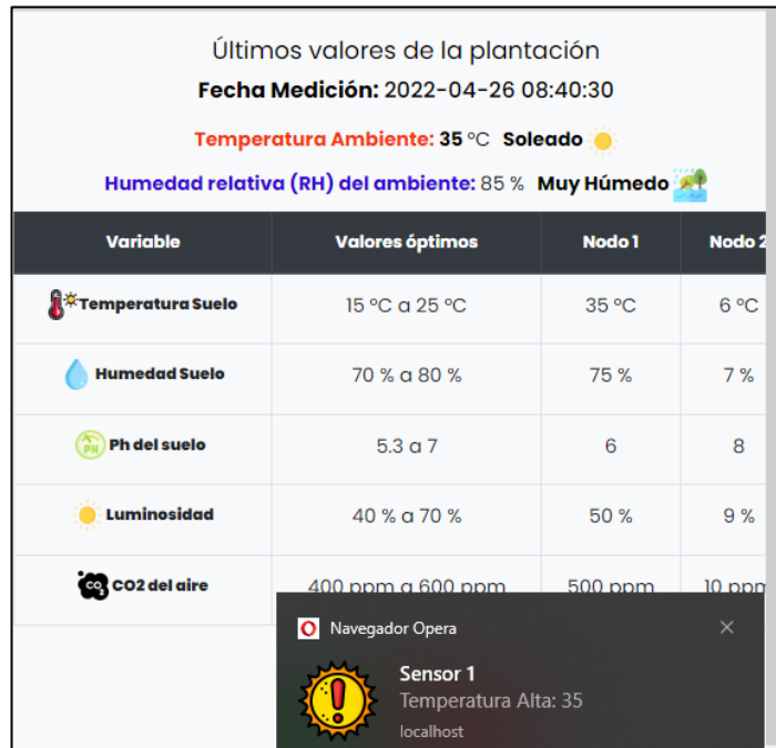
Figura 64: Pruebas de alarmas del sistema temperatura mayor al rango óptimo.
