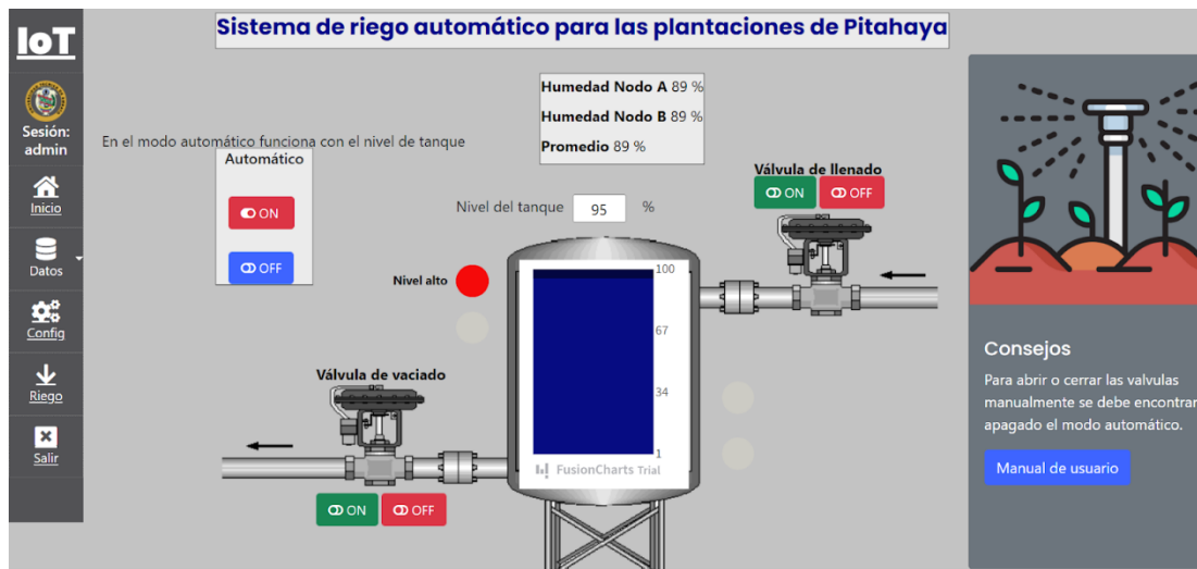
Figura 88: Alarma del nivel del tanque lleno.
