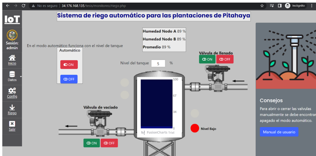
Figura 89: Nivel bajo del tanque.
