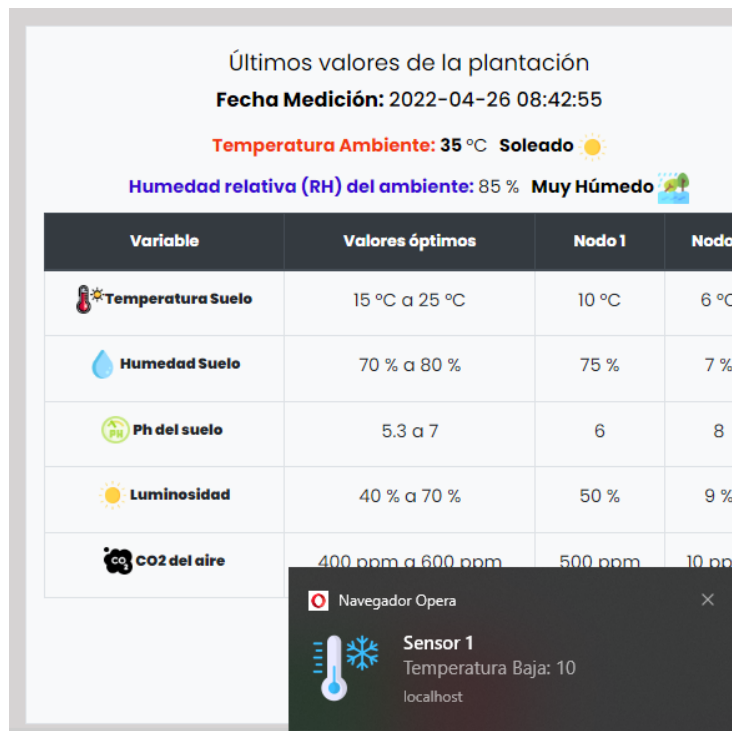
Figura 65: Prueba de alarma temperatura baja.
