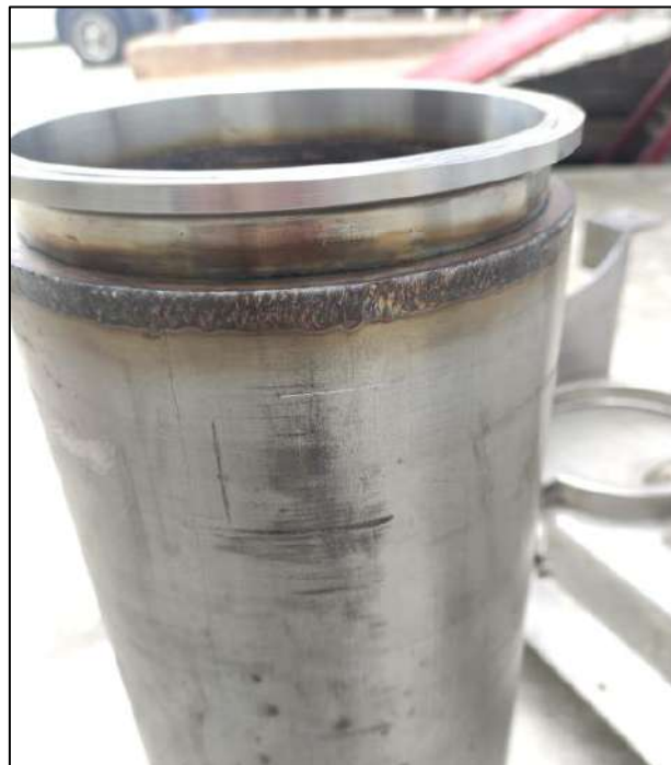
Fotografía 5.2: Cilindro de llenado con Ferrul de 6".
