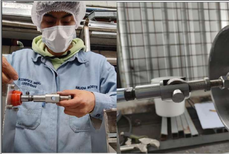
Fotografía 5.13: Ensamble de rotula y Horquilla.
