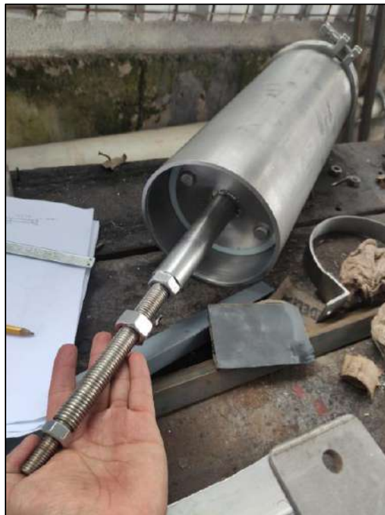
Fotografía 5.14: Ensamble esparrago, cilindro de llenado y embolo.
