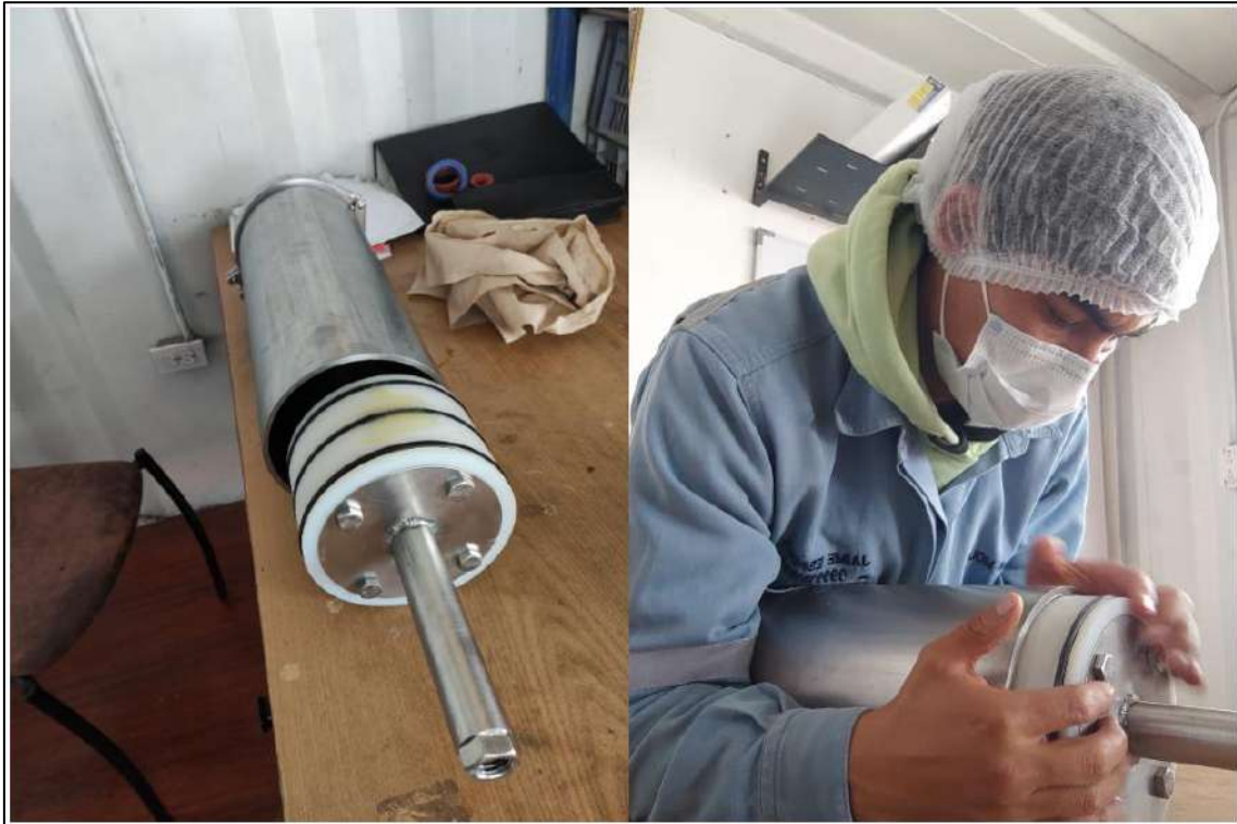
Fotografía 5.11: Ensamblaje Cilindro de llenado y embolo.
