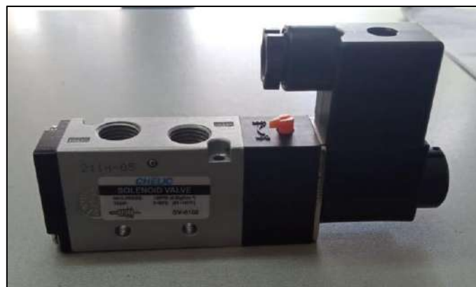
Figura 2.5: Electroválvula y sus partes normalmente cerradas de dos vías. [28].
