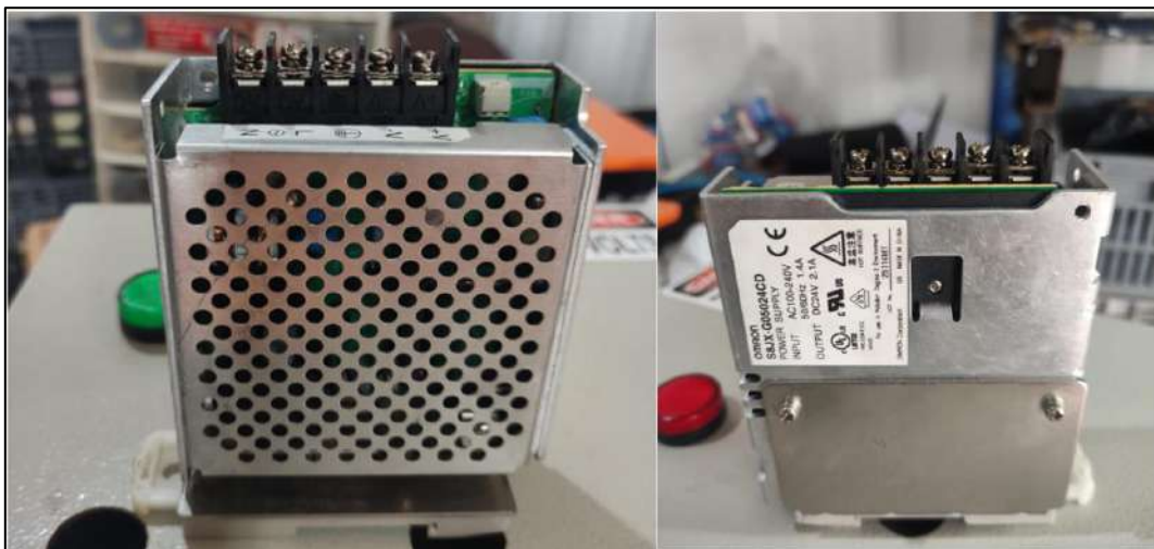
Figura 2.9: Fuente de poder de 110 – 240 v a 24 v DC [43].
