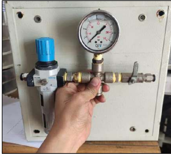
Figura 2.14: Unidad de Mantenimiento [6].
