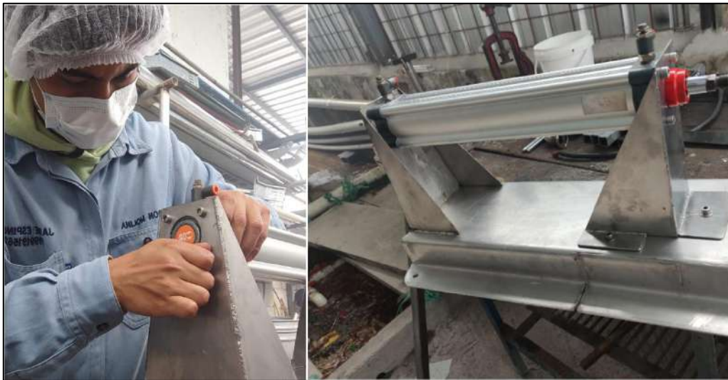
Fotografía 5.12: Ensamblaje Cilindro neumático base.
