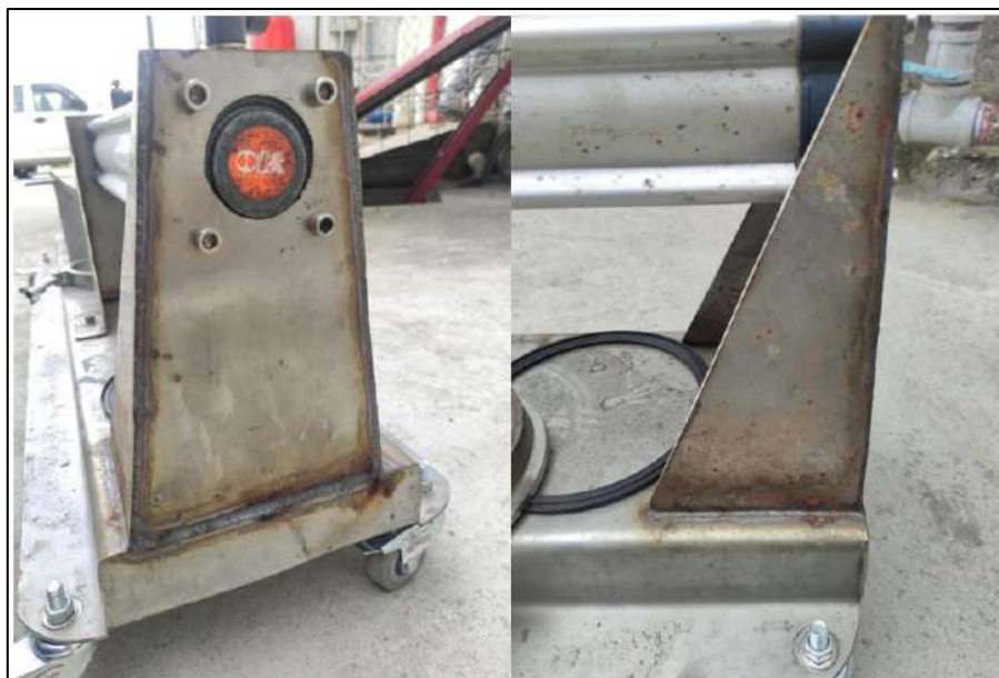
Fotografía 5.4: Unión base del cilindro neumático con la estructura principal.
