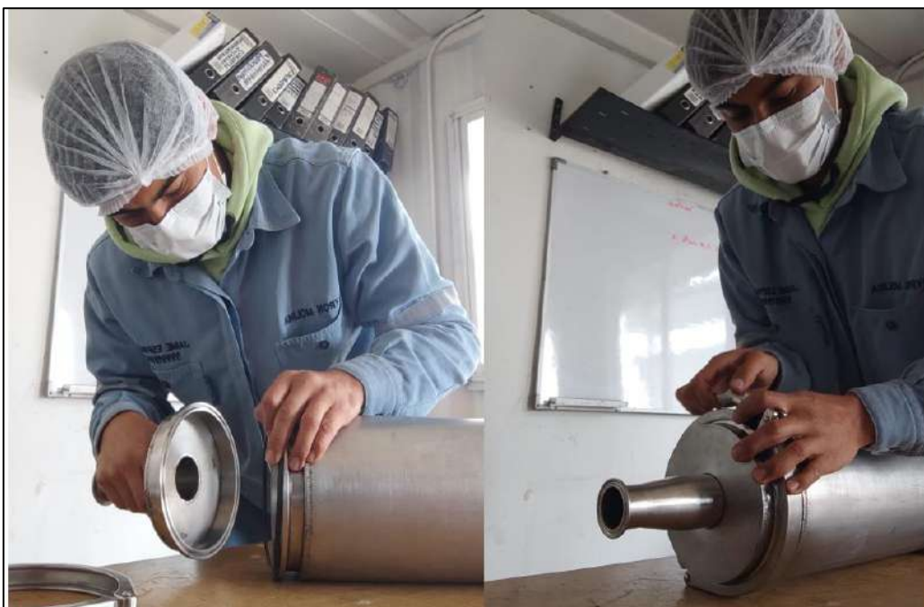
Fotografía 5.10: Ensamblaje Cilindro de llenado.
