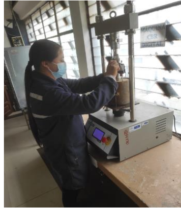
G2.10 Ensayo CBR.
