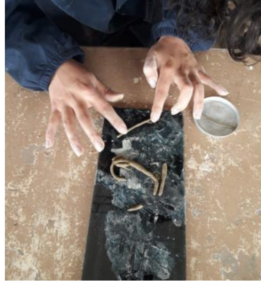
G2.6 Rollitos de suelo en placa de vidrio.
