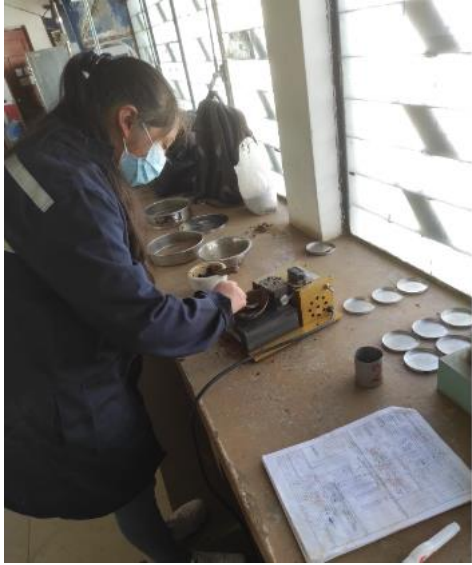
G2.5 Ensayo en la copa Casagrande.
