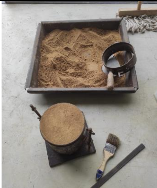
G2.7 Molde con suelo compactado.
