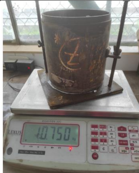
G2.8 Pesando el molde con suelo húmedo.
