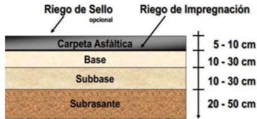
Figura 15. Capas de pavimento flexible.
