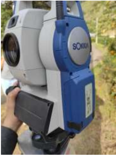
Fotografía N°3 Georreferenciación de puntos de control mediante Estación Total
