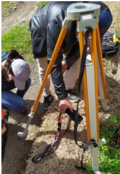
Fotografía N°2 Georreferenciación de puntos de control mediante GPS
