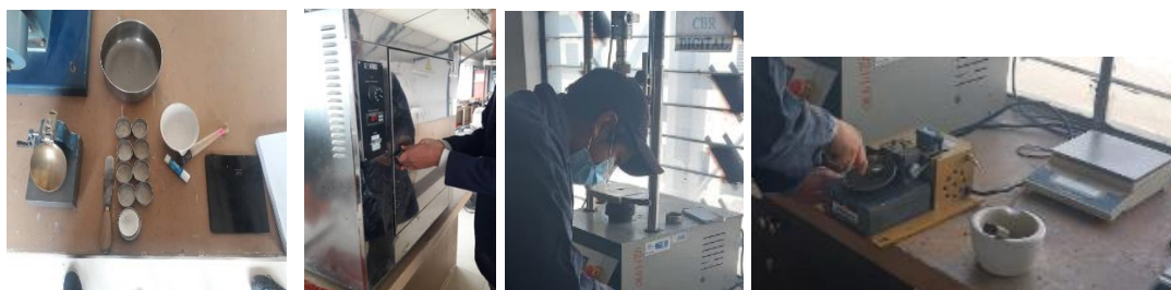
Figura 38. Equipos para ensayo de suelos
