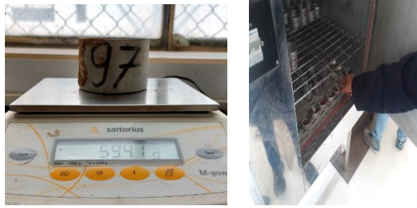
Figura 42. Ensayo contenido de humedad
