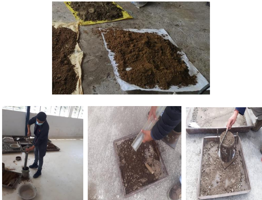
Figura 48. Proceso de compactación
