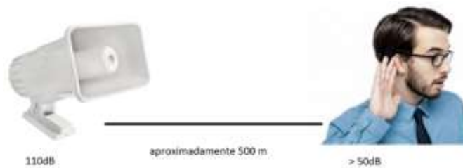
Figura 43: Distancia aproximada de propagación del sonido de la sirena
