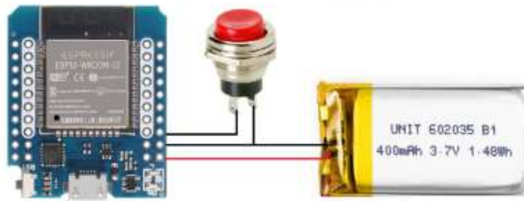
Figura 13: Diseño esquemático del pulsador SOS
