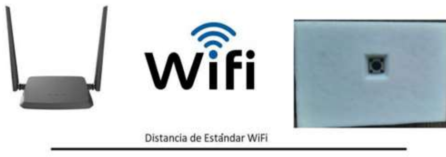
Figura 14: Pulsador WiFi elaborado para el prototipo
