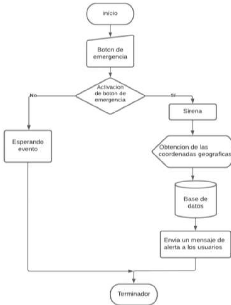
Figura 20: Algoritmo de programación de la base de datos del sistema
