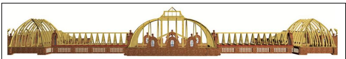
Figura 15. Cubierta del Edificio del Colegio Benigno Malo construida con madera de Eucalipto.
