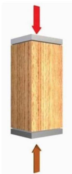
Figura 7. Esquema de ensayo de compresión paralela a las fibras
