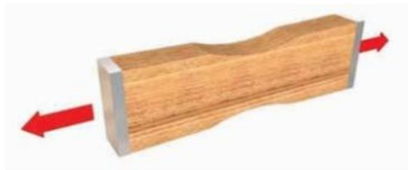
Figura 9. Esquema de ensayo de tracción paralela a las fibras
