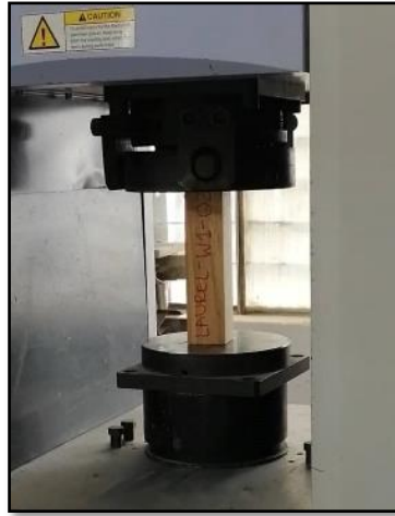
Figura 30. Probeta al inicio del ensayo mecánico de compresión paralela
