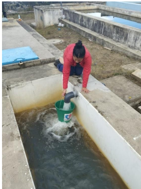
Imagen 14. Toma de caudales de salida
