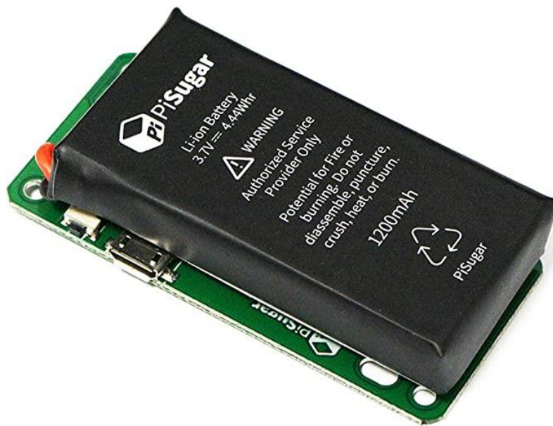
Figura 13. Módulo de alimentación de batería de litio PiSugar para Raspberry Pi Zero W.
