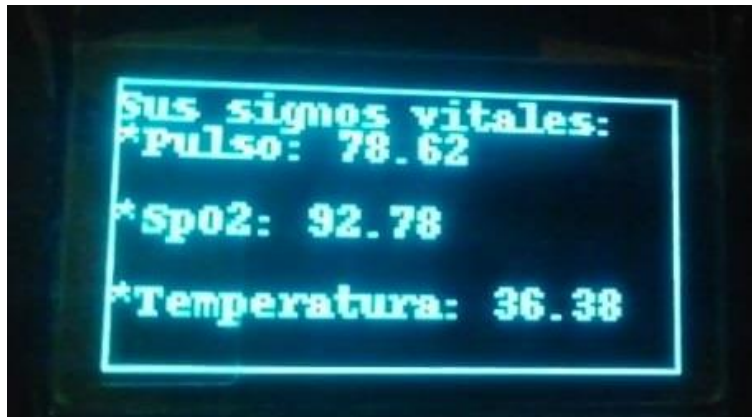
Figura 43. Visualización de signos vitales en la pantalla OLED. Elaborado por el investigador.
