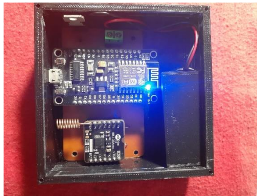
Figura 73.- Recepción de mensajes por modulación LoRa.
