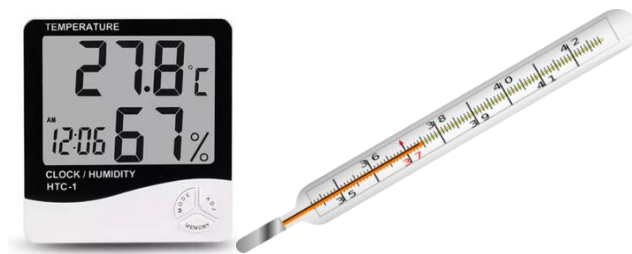
Figura 67.- Higrómetro digital HTC-1 y termómetro de mercurio [94]
