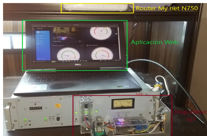
Figura 101: Sistema implementado en el equipo transmisor de RF en los laboratorios de Ecuatronicx
