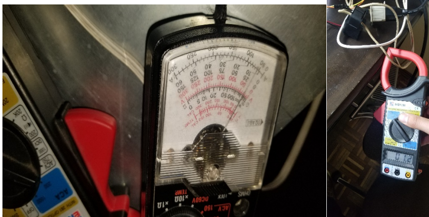
Medición del amperaje consumido por el equipo y el dispositivo IoT
