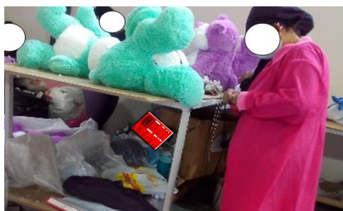
Figura 42: Colocación de la tarjeta roja en el área de terminado
