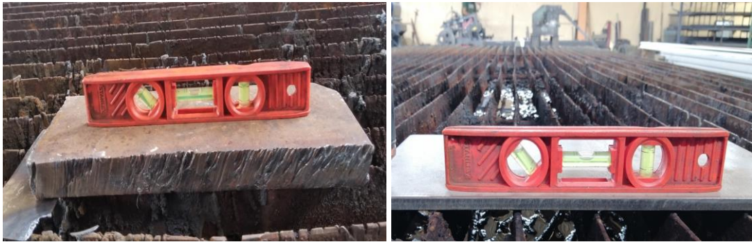
Figura 2. Ubicar y nivelar la pieza a cortar.
