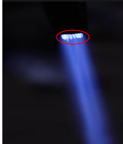
Figura 20. Picos azules en la base de la boquilla.
