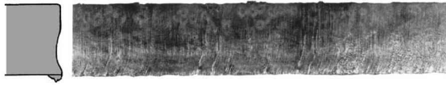
Figura 1.21. Efecto de la boquilla sucia por escoria [23].
