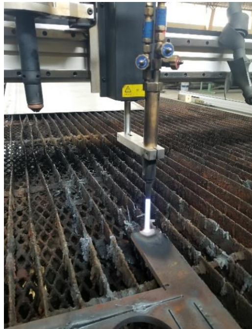
Figura 19. Regulación de la boquilla de precalentamiento.
