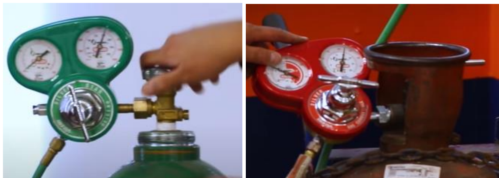
Figura 5. Apertura del cilindro de oxígeno y acetileno.
