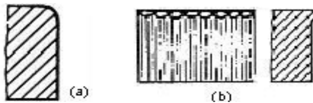
Figura 1.22. Defectos por la fusión del borde superior [27].
