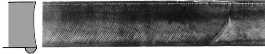
Figura 1.18. Efecto de corte alta velocidad [23].
