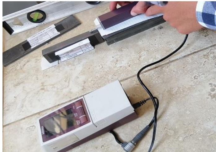
Figura 3.6 Obtención del muestreo de rugosidad media.
