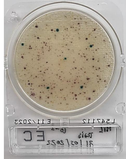
Muestra: Mercado Central puesto 1 día Lunes Dilución: 10^{-2} Observación: Presencia de E.coli / coliformes
