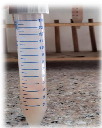
Figura 5: Muestra centrifugada por 15 min a 10,000 rpm.
