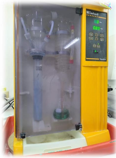
Figura 7: Destilación de la muestra (Destilador de proteína VAPODEST GERHARDT).
