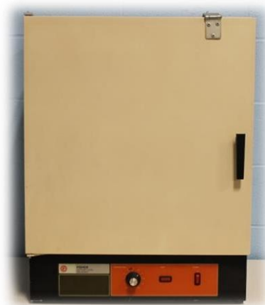
Figura 2: Estufa FISHER ISOTEMP OVEN 200 SERIES para medir humedad.
