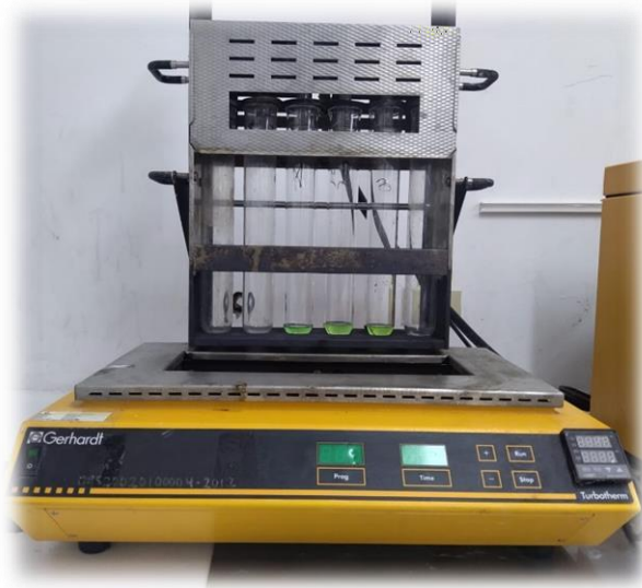
Figura 6: Digestión de la muestra (Digestor Gerhardt Turboder).
