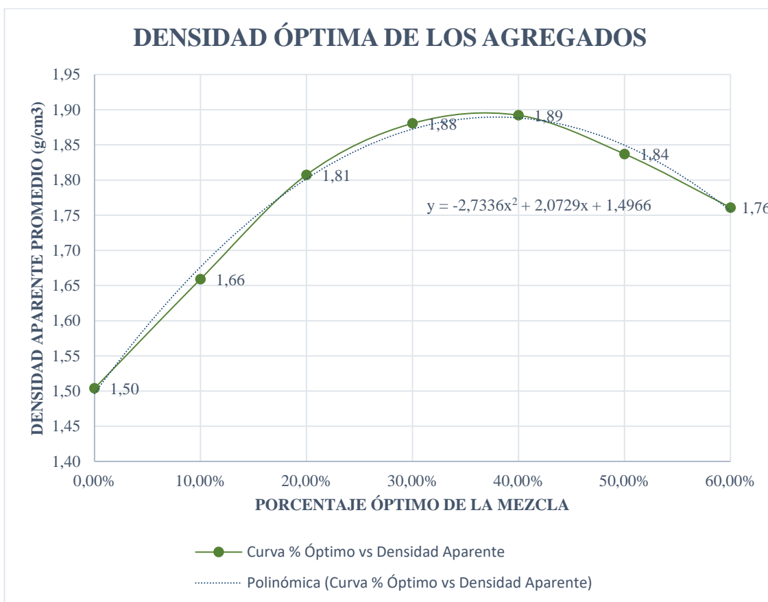
Figura 9. Densidad óptima de los agregados de la "Planta de Asfalto GAD Municipal de Tena".
