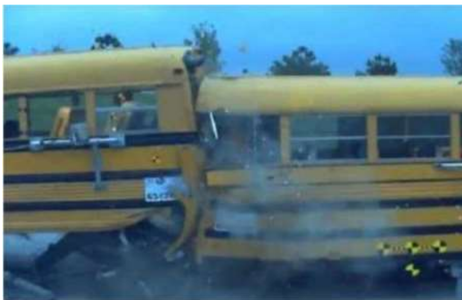
Figura 1.15 Ensayo de impacto de buses escolares [22]
