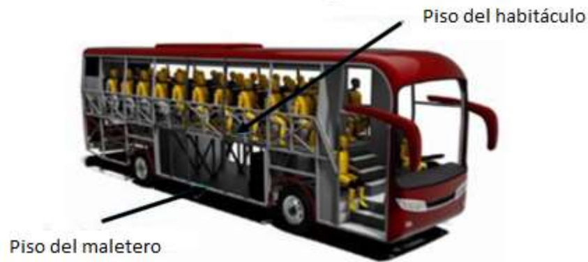
Figura 1.6 Armazón del piso del habitáculo y del maletero.
