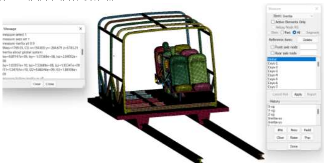
Figura 2.12 Peso total de la estructura más el maniquí.
