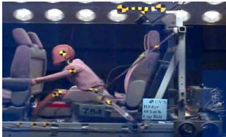
Figura 1.13 Dummy en un impacto frontal [21].
