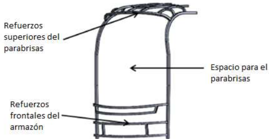
Figura 1.4 Armazón delantero del autobús [10].
