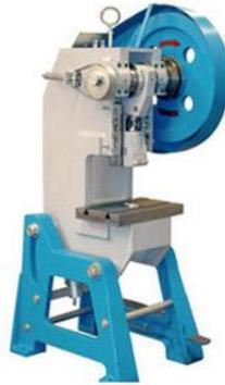
**Figura 2:** Máquina troqueladora mecánica de 45 toneladas.
