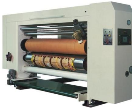
**Figura 3:** Máquina troqueladora rotativa.
