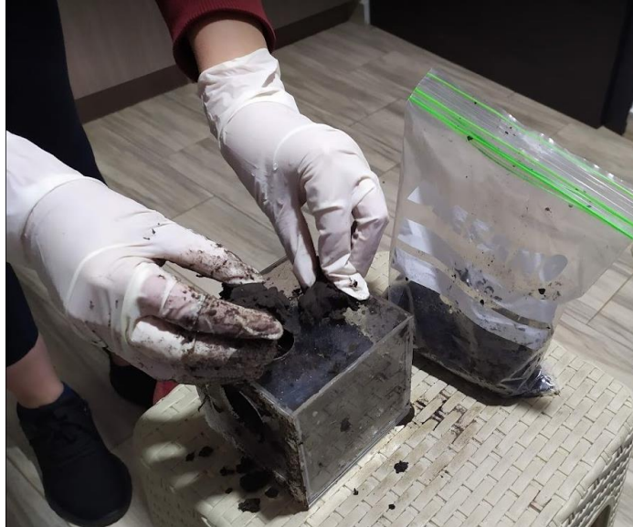
Figura 4-2: Colocación de lodo en la cámara ánodo Fuente: Autora
