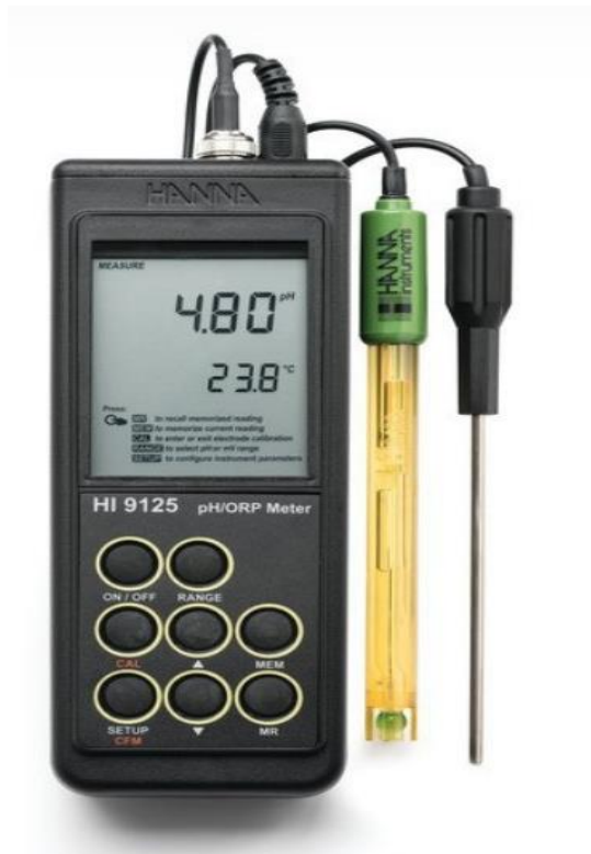
Fig. B-5: Sensores utilizados para la medición de Ph, temperatura Fuente: Investigador
