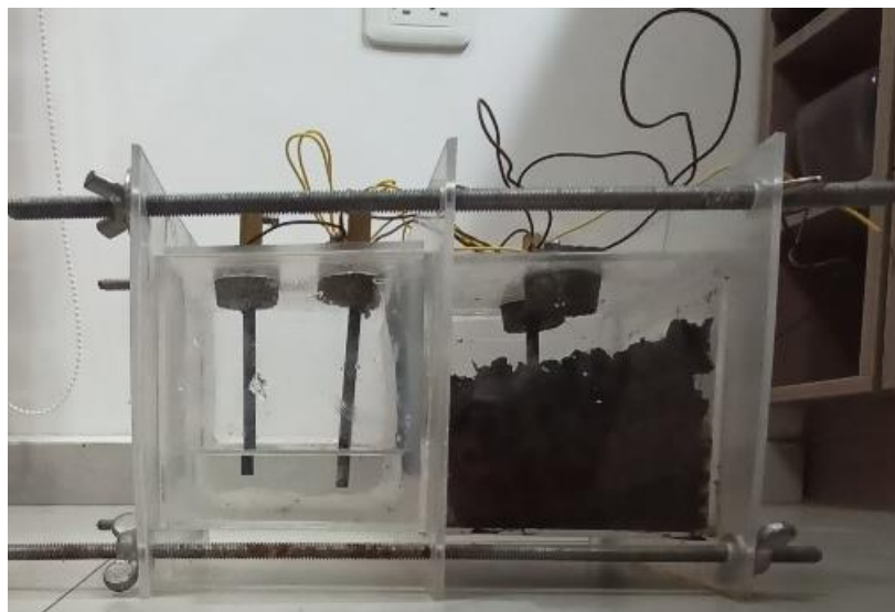
Figura 4-3: Resultado celda de combustible microbiana Fuente: Autora
