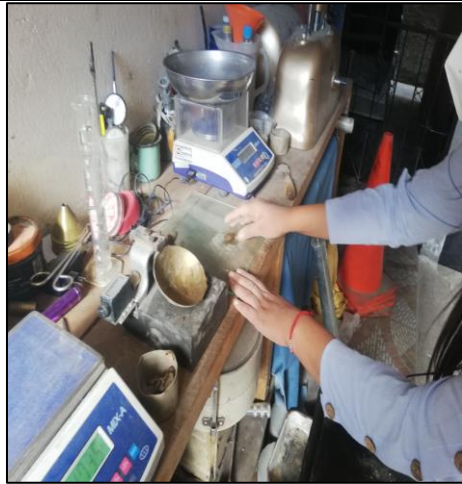
Determinación del límite plástico
