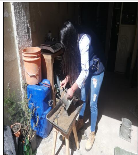
Enrazamiento de la muestra compactada
