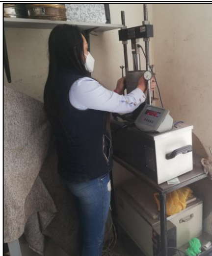
Ensayo de penetración en la máquina de Prensa de Carga
