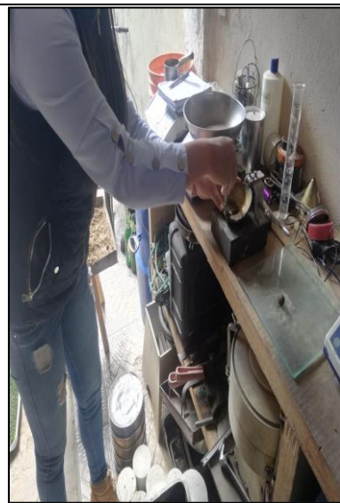
Determinación del límite líquido
