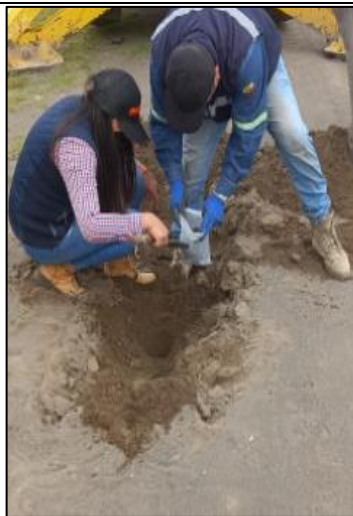
Toma de muestras para contenido de humedad
