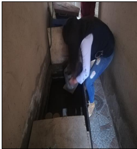
Sumergimiento de muestras en CBR
