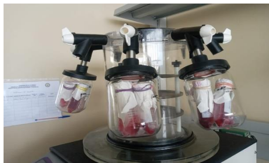
Figura 11. Secado por liofilización del aislado proteico de geranio a un pH de 3,0.
