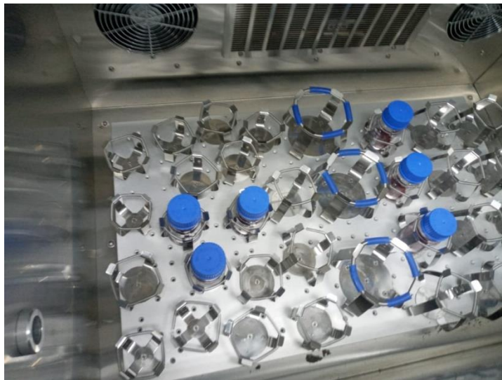
Figura 14. Agitación orbital de las muestras de la digestión in vitro (120 min de digestión gástrica y 120 min de duodenal).
