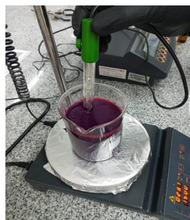
Figura 6. Proceso de agitación y ajuste de pH a 8.0 de geranio (2N NaOH).
