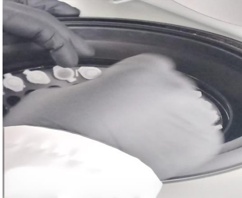
Figura 33. Centrifugado para obtención del sobrenadante de reacción para medición de absorbancias.
