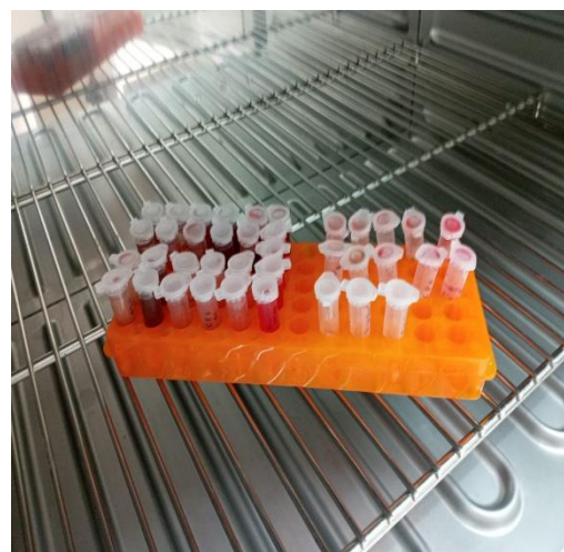
Figura 32. Incubación de la muestra de reacción a 37 °C por 30 min.
