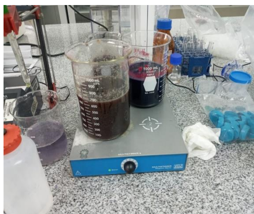
Figura 5. Precipitación de la muestra con agua destilada.
