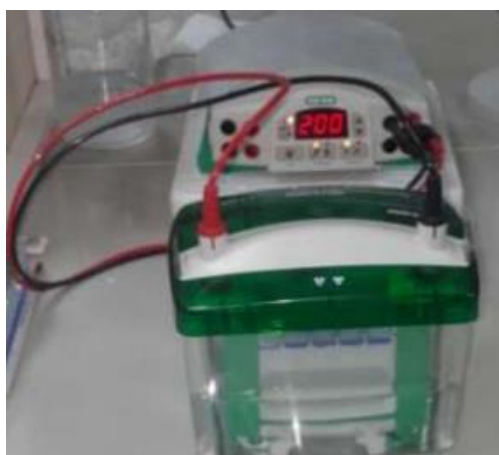
Figura 21. Corrida electroforética a 200 V por 45 min del gel con las muestras.
