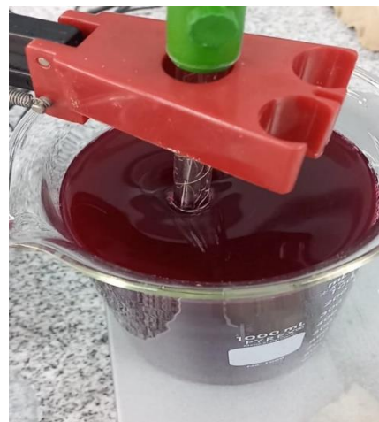
Figura 10. Proceso de agitación y ajuste de pH 3.0 de precipitación con HCL 2N
