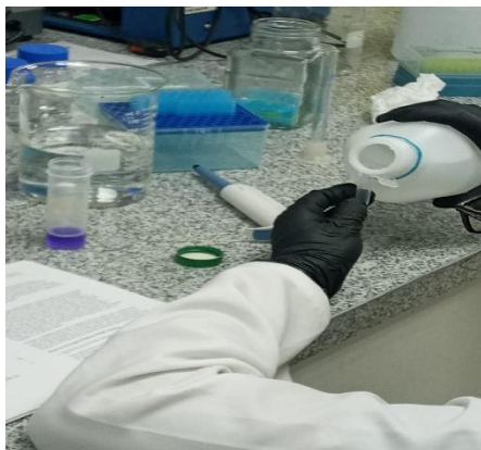
Figura 17. Preparación del buffer running para la cámara electroforética.
