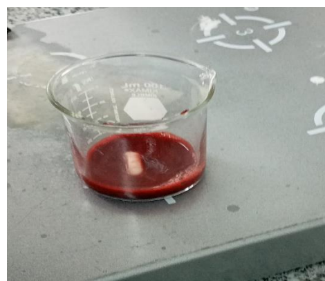
Figura 31. Agitación de la muestra de sangre reconstituida con solución isosalina.
