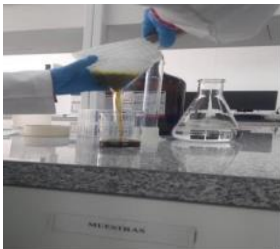
Figura 9. Proceso de filtración
