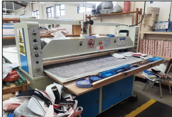
Figura 17: Corte por troquel 2.
