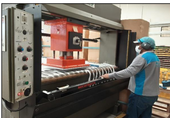
Figura 16: Corte por troquel 1.
