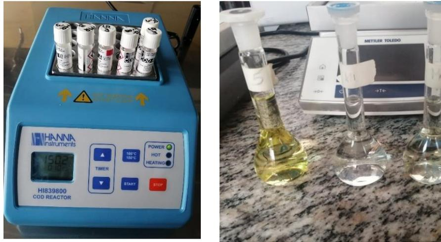
Figura 18. Determinación de hierro, fosfato y DQO presente en los DAM.
