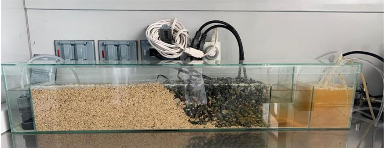
**Figura 8.** Sección de neutralización, sedimentación y filtro de piedra caliza de la planta piloto instalada
