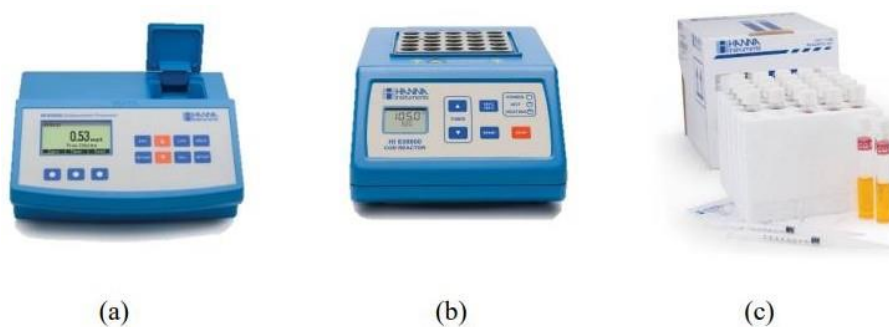
Figura 6. Equipo y reactivo para la obtención de la DQO (Hanna instrument)
