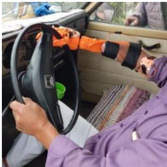
Figura 89. Prueba de funcionamiento en paciente, agarre en función del voltaje.
