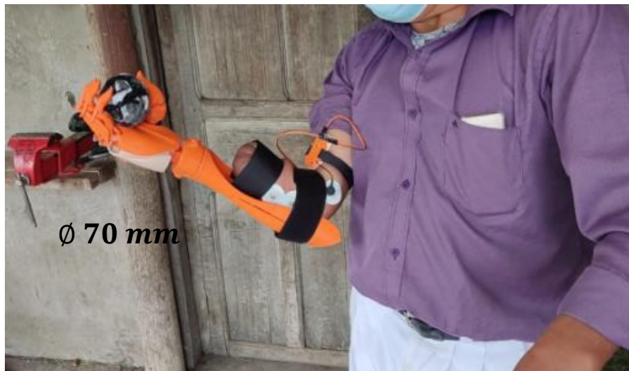
Figura 85. Prueba de funcionamiento en paciente, agarre esférico.
