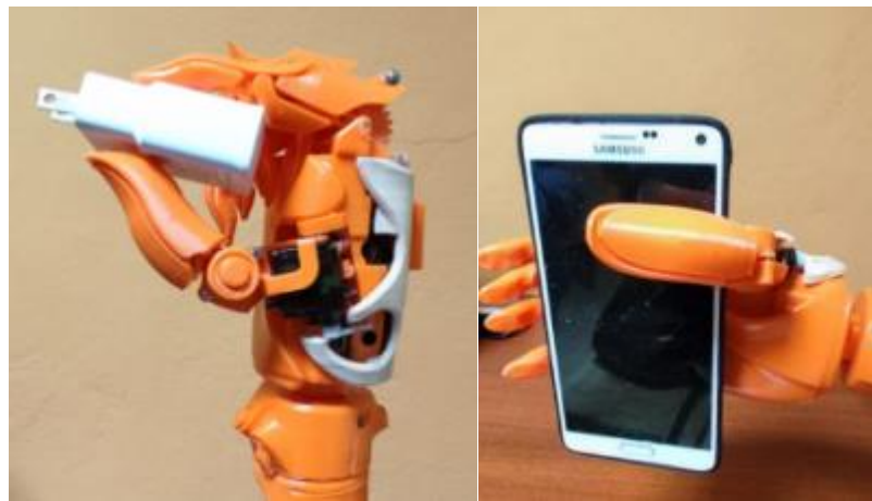
Figura 88. Prueba de funcionamiento agarre en función del voltaje.
