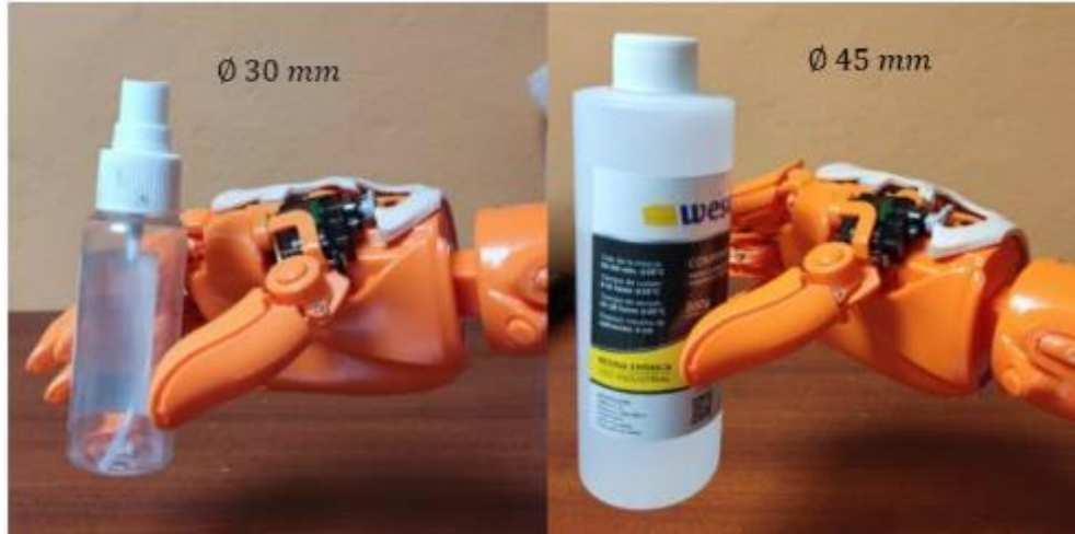
Figura 82. Prueba de funcionamiento - Agarre Cilíndrico
