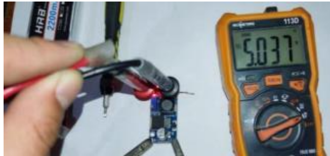
Figura 37. Regulación de voltaje a 5V Elaborado por: Investigador
