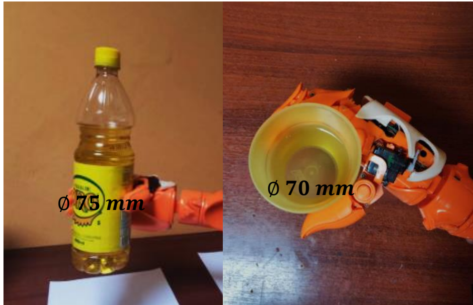
Figura 84. Prueba de funcionamiento - Agarre cilíndrico, esférico
