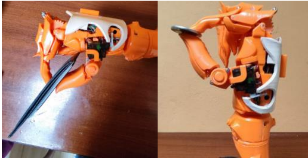
Figura 86. Prueba de funcionamiento - Agarre pinza
