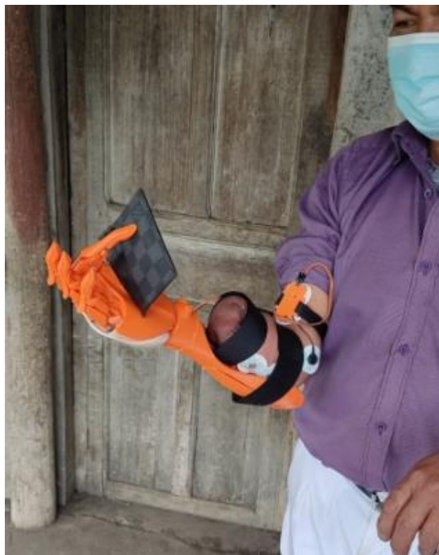
Figura 87. Prueba de funcionamiento en paciente, agarre pinza.
