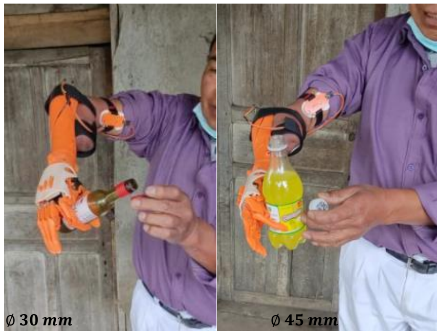
Figura 83. Prueba de funcionamiento en un paciente, agarre cilíndrico.
