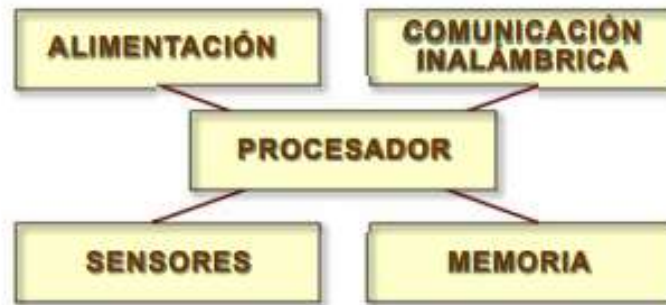
Figura 7. Arquitectura de un Nodo Inalámbrico [41].
