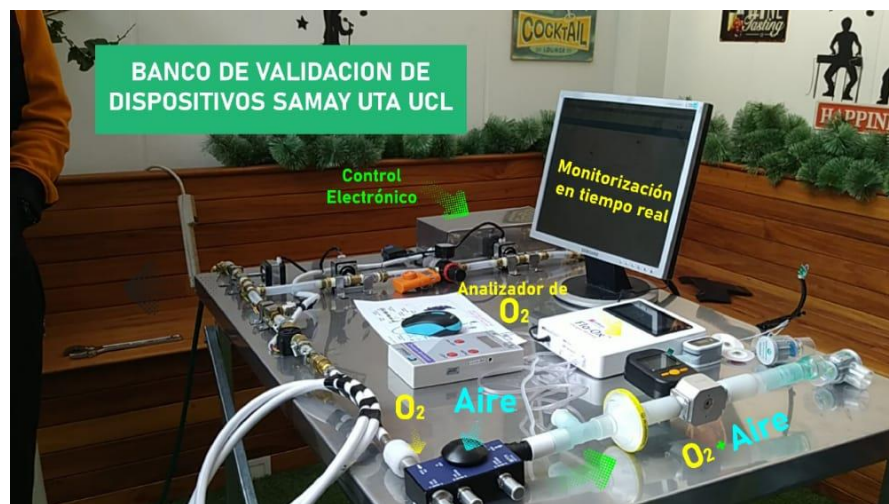
Figura 3- 16 Layout del Banco de pruebas
