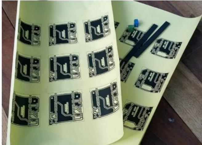
**Figura 84:** Impresión de los circuitos en papel transfer
