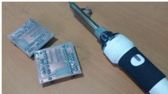
**Figura 91:** Soldado de los componentes electrónicos en la placa
