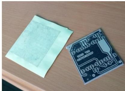
**Figura 87:** Transferencia del diseño a la baquelita
