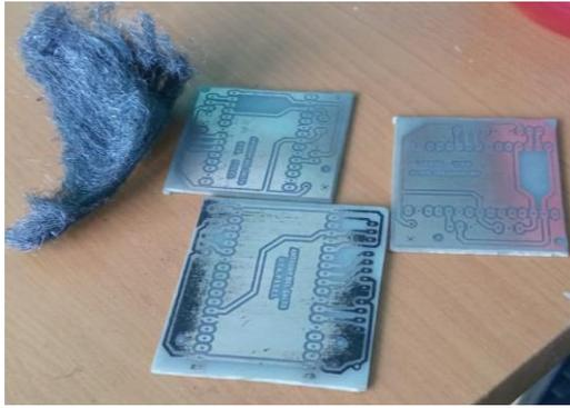
**Figura 89:** Retiro de la máscara de tinta y lijado de la placa
