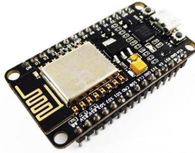
**Figura 15:** Módulo NodemCU [26]
