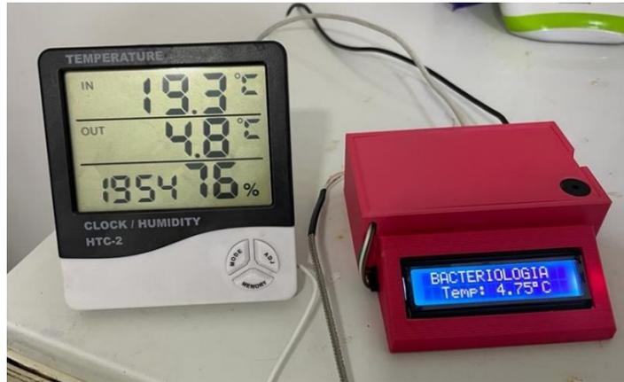
**Figura 112:** Medición comparativa de la temperatura de la refrigeradora del área de bacteriología
