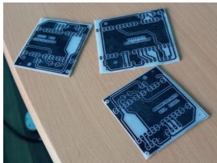
**Figura 88:** Placa grabada con su respectivo esquema
