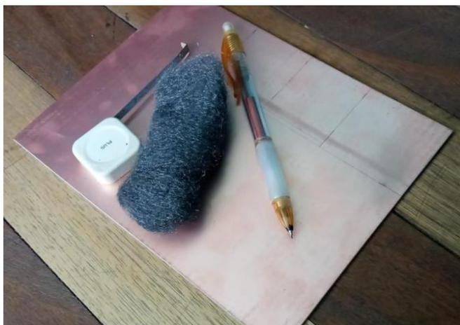
**Figura 85:** Baquelita lijada con las respectivas medidas
