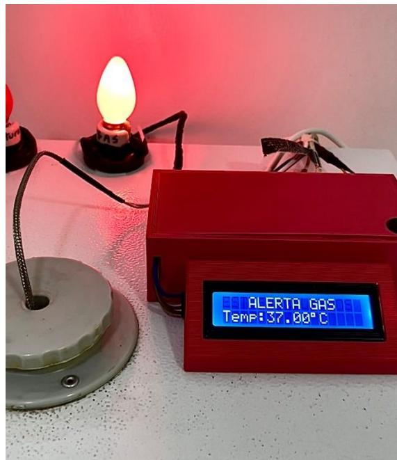
**Figura 126:** Advertencia visual detección de gas en el nodo final
