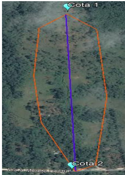
Figura N° 35. Cota máxima y longitud de drenaje de cuenca del estimada del proyecto
