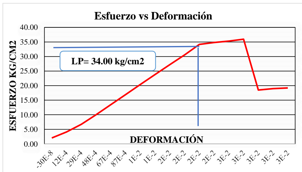
Figura 41. Esfuerzo Limite proporcional de Flexión en la madera de Aliso
