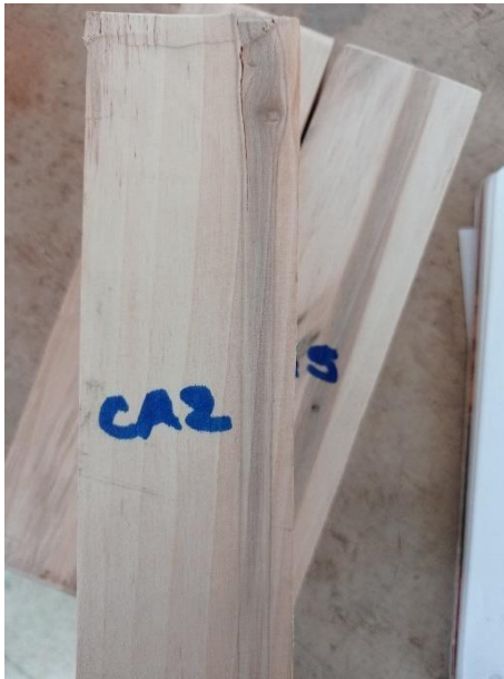
Falla típica de una probeta sometida a una fuerza de compresión paralela.
