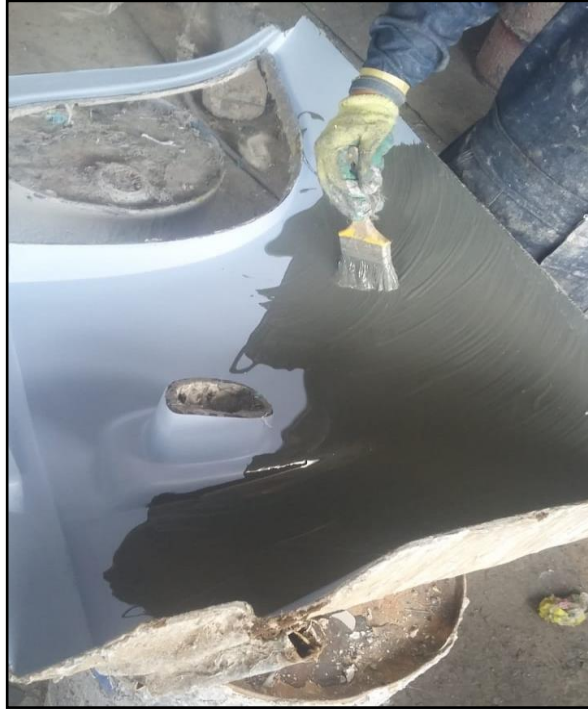
Ilustración 9 Aplicación de Gel Coat
