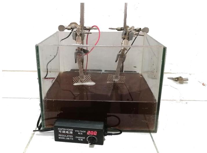
**Figura 3.** Diseño y construcción celda electrolítica
