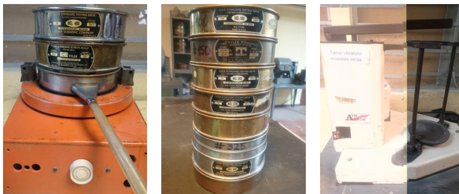
Figura 5. Equipo de tamizado con las mallas utilizadas en el análisis granulométrico.
