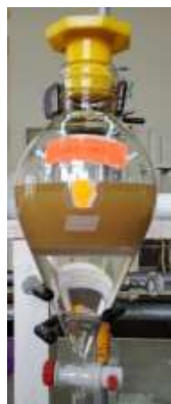
Figura 5. Separación de fase orgánica y acuosa de los ácidos grasos.
