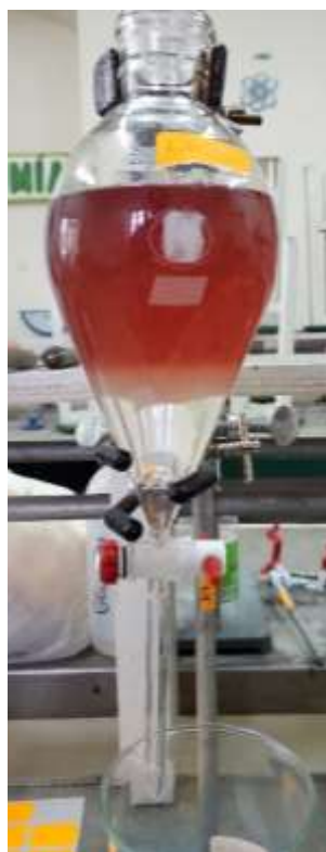
Figura 8. Separación de fases de la base lubricante y catalizador.
