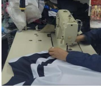
Figura 26. Pespunte delantero en máquina recta.
