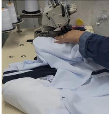
Figura 36. Unión de mangas máquina overlock.
