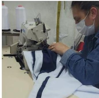
Figura 30. Unión de hombros máquina overlock.
