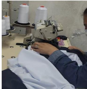
Figura 39. Unión de faja máquina overlock.
