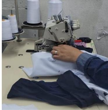
Figura 38. Cerrado de la chompa máquina overlock.
