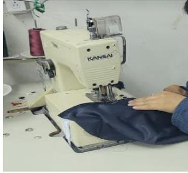
Figura 29. Recubrir capucha en máquina recubridora.
