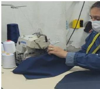
Figura 27. Armado capucha en máquina overlock.
