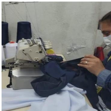
Figura 34. Armado cuello máquina overlock.
