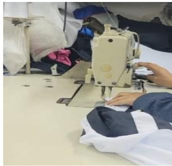
Figura 33. Armado bolsillo máquina overlock.
