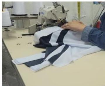
Figura 25. Armado delantero en máquina overlock.
