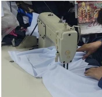
Figura 37. Pespunte de mangas máquina recta.
