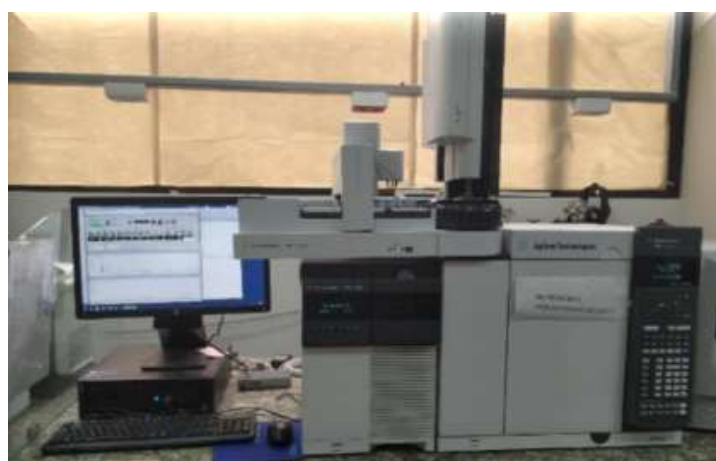
Figura 19. Cromatógrafo de gases AGILENT TECHNOLOGIES 7890B GC SYSTEM acoplado a un detector de masas 5977A GC/MSD
