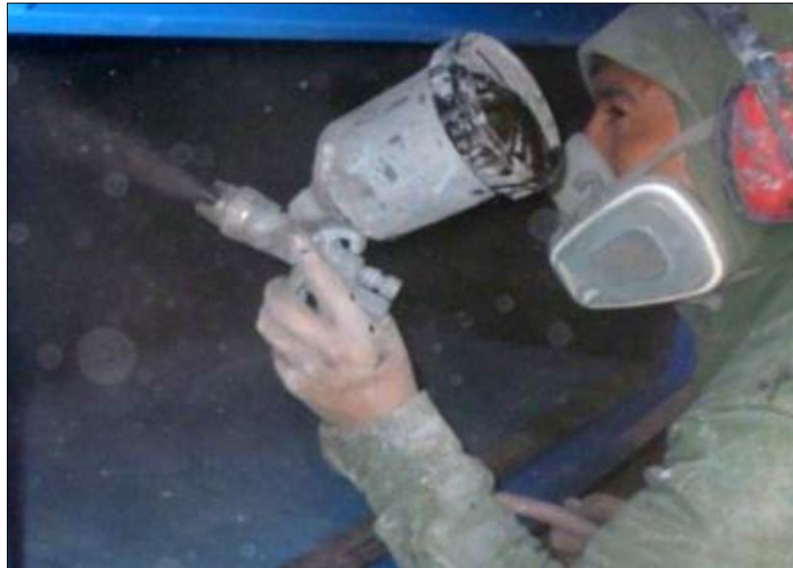
Figura 16: Calafateo de la parte inferior de la carrocería.
