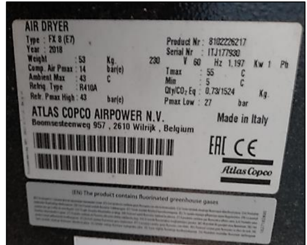
Figura 32: Placa de identificación del secador de aire comprimido.
