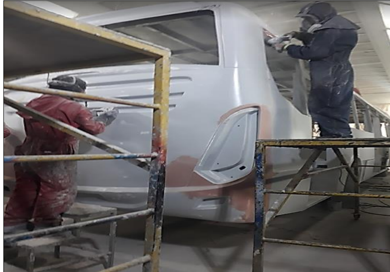
Figura 12: Aplicación de masilla en diferentes superficies.
