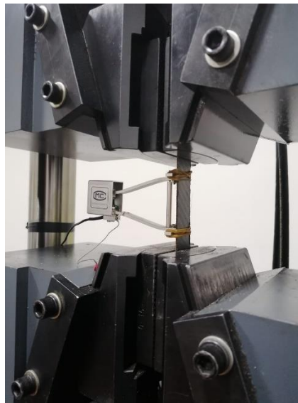
Figura 2. 4 Máquina Universal (WAW600B) para ensayos de tracción
