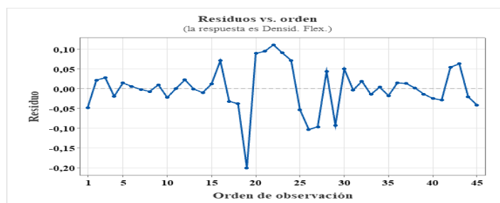
Figura 3.51 Gráfica del Orden de observación vs. Residuos de la densidad de las probetas a flexión
