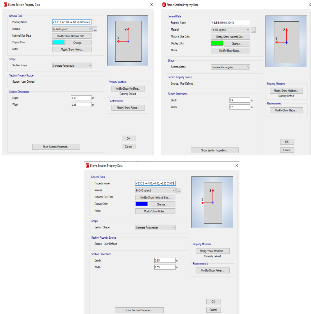
Figura 47: Definición de vigas
