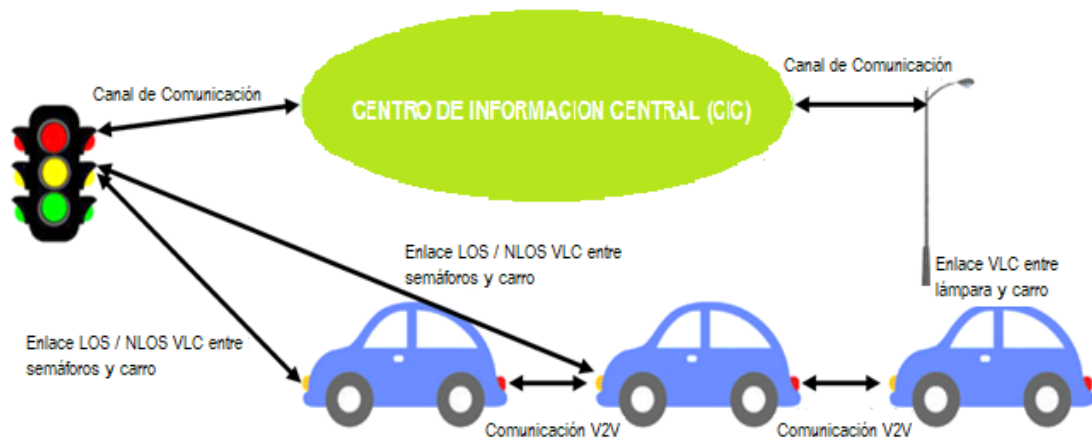
Figura 2.18: Elementos del sistema de transporte inteligente. LOS, línea de visión; NLOS, sin línea de visión; VLC, comunicación de luz visible; V2V, vehículo a vehículo
