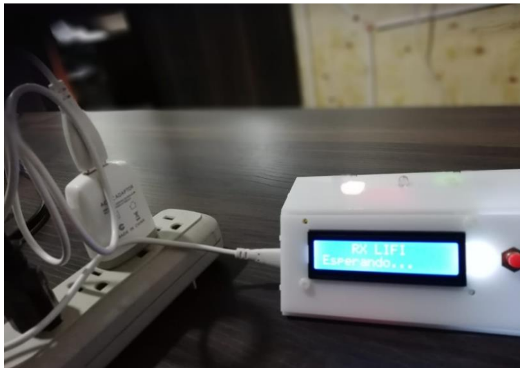
Figura 4.44: Conexión de Receptor LIFI a un adaptador de voltaje
