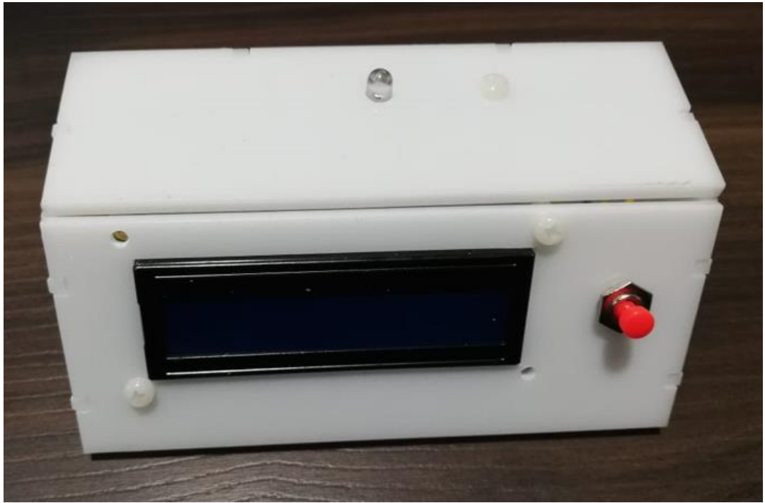
Figura 4.34: Receptor con Sensor con diodo fotosensible LIFI
