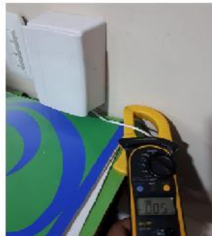
Corriente del Tx LIFI de 4V conectado
