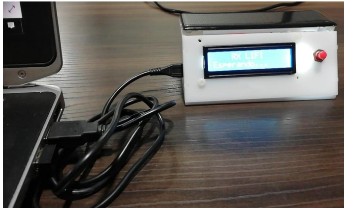
Figura 4.43: Conexión de Receptor LIFI a un puerto USB
