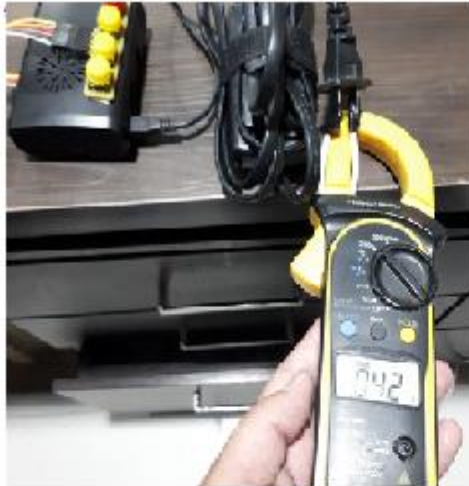
Corriente del Servidor MQTT conectado
