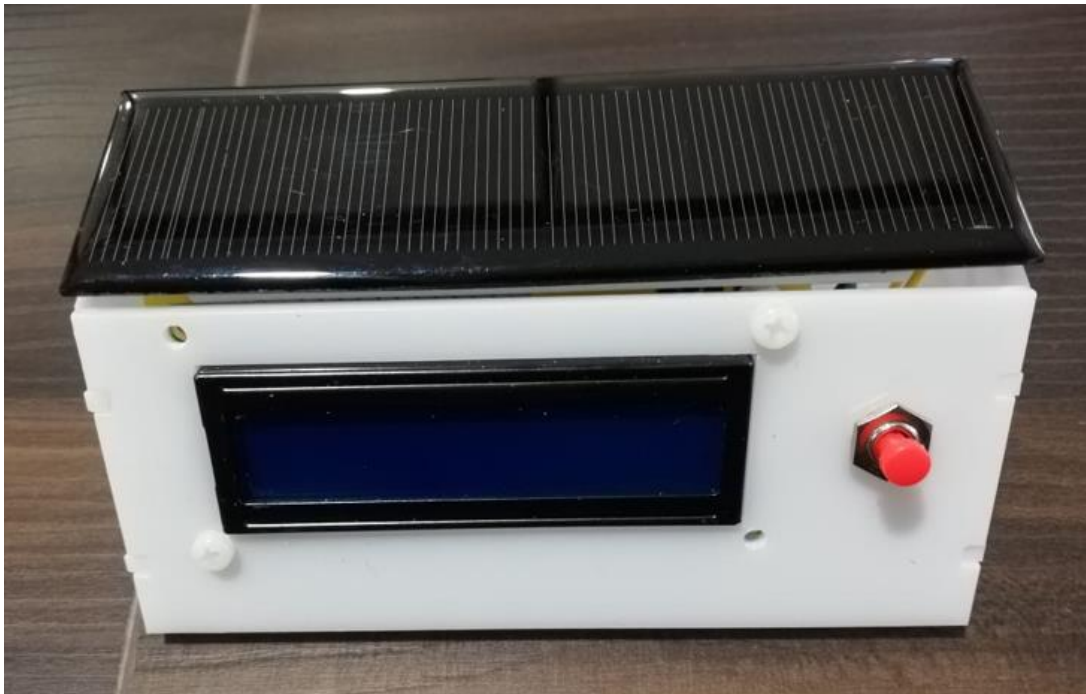
Figura 4.33: Receptor con Panel Solar FILI
