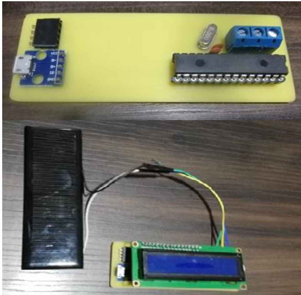
Figura 4.30: Conexión de elementos para receptor con panel solar Fuente: Investigador
