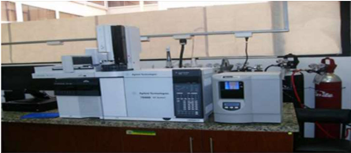
Figura 4. Cromatógrafo de gases Agilent Technologies 7890B GC System con detector de masas Agilent Technologies 5977A MSD.
