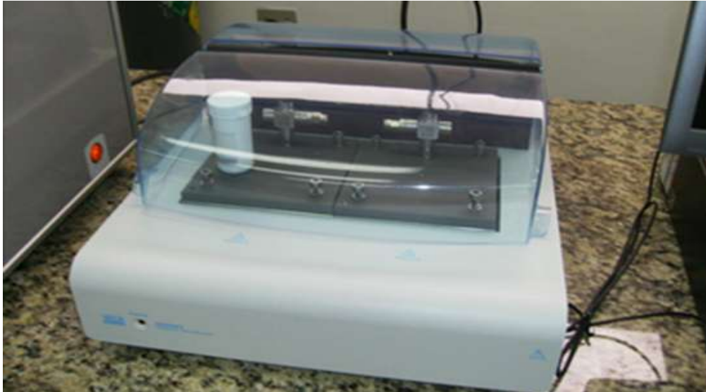
Figura 8. Equipo para determinar la estabilidad a la oxidación de aceites OXITEST.
