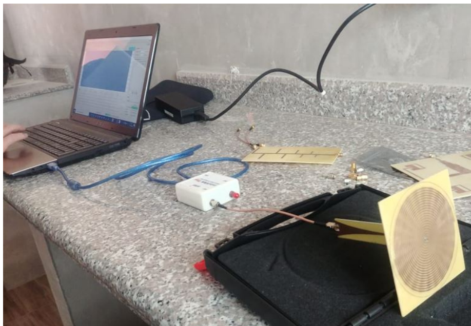
Figura 4.15: Conexión de la Antena fabricada al analizador MiniVNA-TINY
