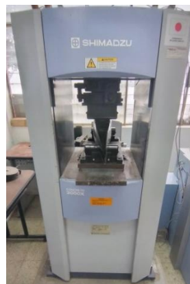
Figura 33. Ensayo de flexión de 3 puntos de los componentes Wing Tip-Fairing Assy reparados.
