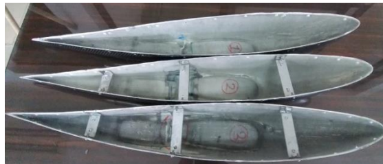
Figura 32. Instalación de topes en las piezas reparadas previo al ensayo de flexión de 3 puntos.
