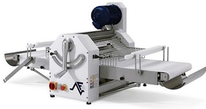
Figura 1.16 Laminadora de sobremesa [37].
