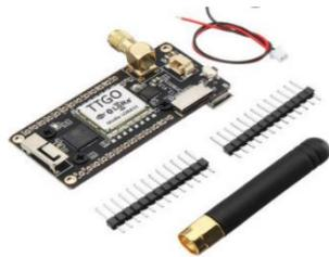
**Figura 5:** Tarjeta Esp32 LoRa con configuración nodo [31]
