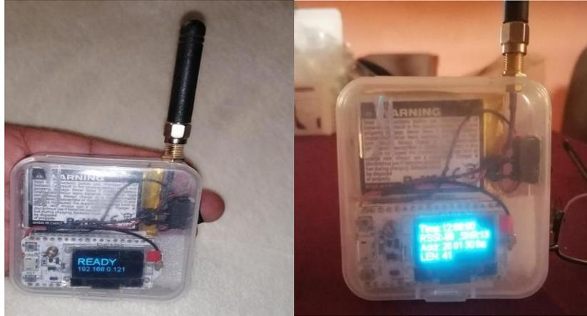
**Figura 28:** Implementación del LoRa Gateway.
