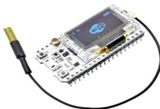
**Figura 6:** Tarjeta Esp32 LoRa con OLED con configuración Gateway [31]
