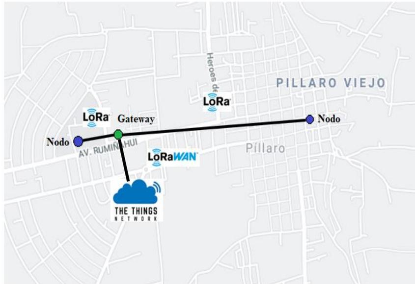
**Figura 14:** Diseño y ubicación de los equipos del sistema
