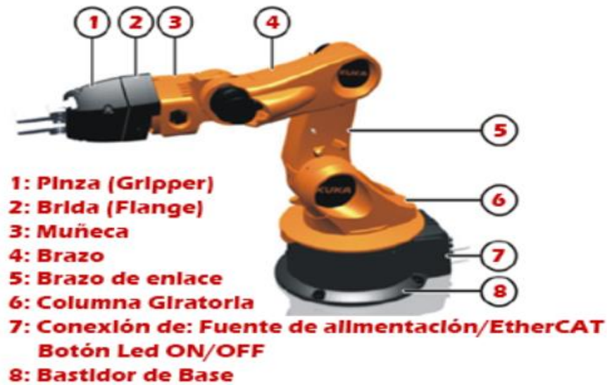
Figura 11: Partes del Brazo Youbot Fuente: Investigador (Photoshop)
