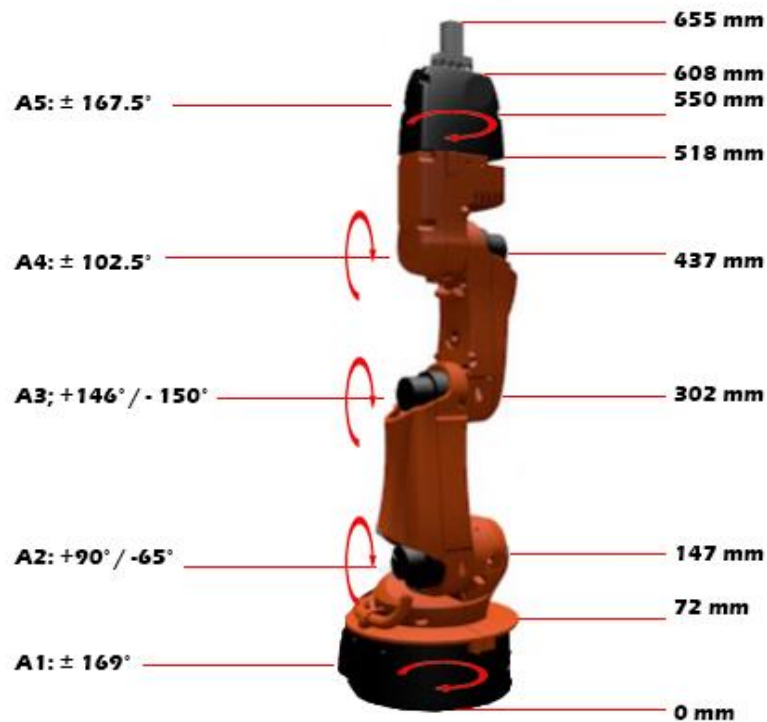
Figura 18: Estructura cinemática del brazo. Fuente: Investigador (Photoshop)
