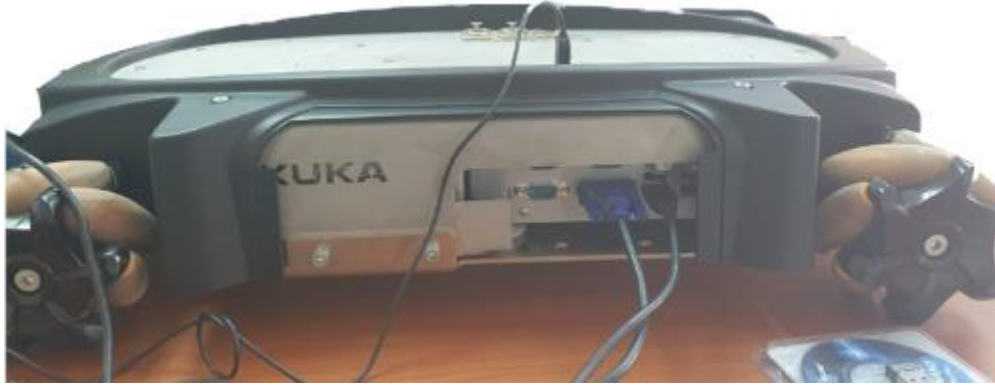
Figura 16: Dispositivos E/S Youbot Fuente: Investigador
