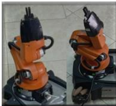
Figura 17: Posición inicial del brazo Youbot Fuente: Investigador
