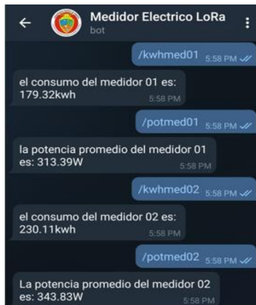
Figura 93: Uso de comandos para interactuar con el bot en Telegram Elaborado por: El Investigador
