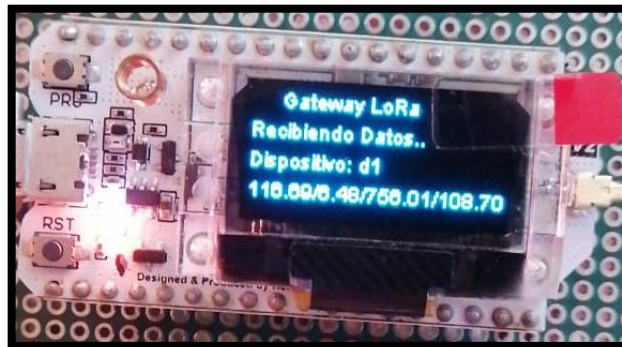
Figura 87: Gateway recibiendo datos desde los nodos finales
