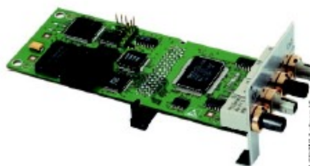
Figura 47.- Módulo de comunicaciones doble anillo
