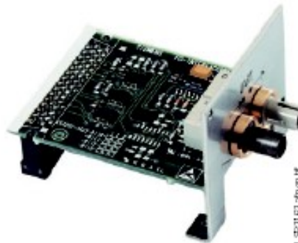
Figura 46.- Módulo de comunicación fibra óptica
