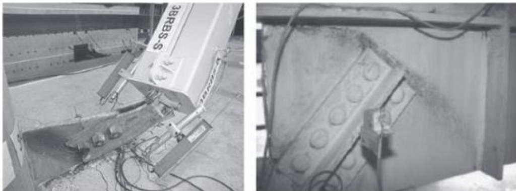
Figura 27: a) Unión de la cartela no reforzada
