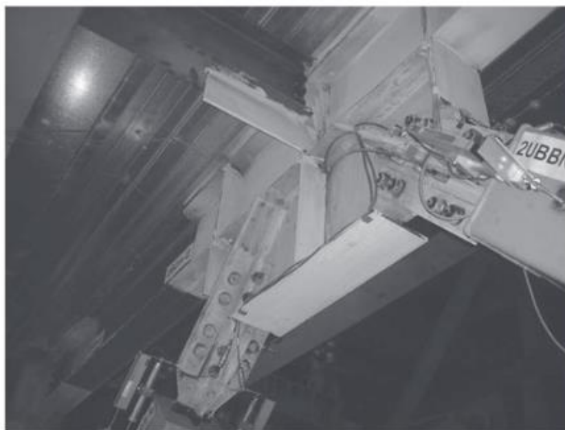
Figura 28: b) Unión de la cartela reforzada en los bordes
