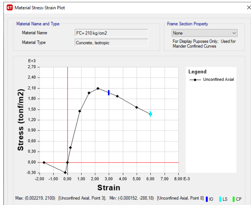
Figura 77: Curva esfuerzo deformación del hormigón
